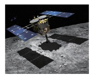
「はやぶさ2」は、目標の小惑星に到着した後、様々な遠隔観測機器と小型のランダとロー バーにより観測を行います。はやぶさ2では国際協力によりドイツ・フランスのランダと日本 のローバーを搭載する予定です。探査機から切り離されたランダとローバーは、小惑星に着 陸し、小惑星表面の詳細な観察を行います。探査機は、その後、小惑星の表面にタッチダウン を行い、小惑星表面の物質を採取します。更に、新規設計の衝突装置により人工クレーター を作り、そこから物質採取を行うことで、小惑星内部からのサンプルリターンも試みます。
